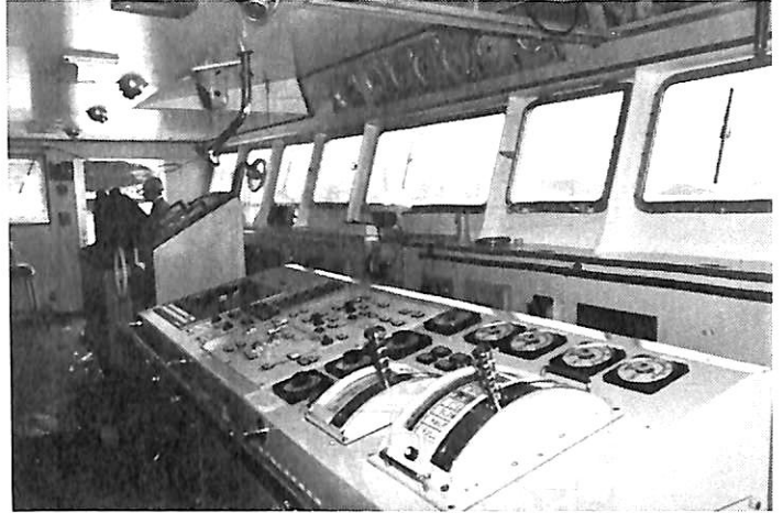
操舵室(主機関操縦装置及び操舵装置)
