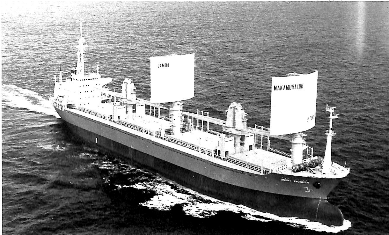
帆走撒積貨物船 USUKI PIONEER 田中産業株式会社 ウスキ バイオニア
