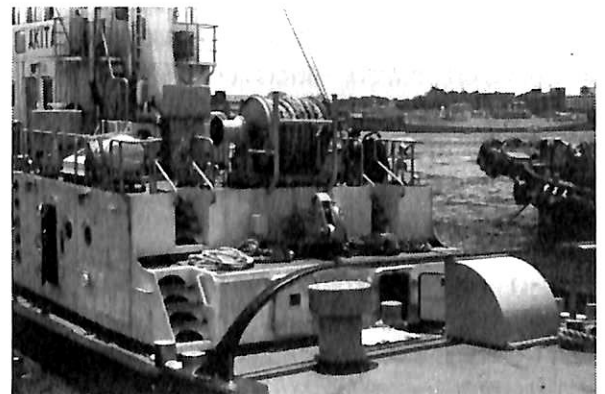
曳航設備(大型用) (中央部ウインチ、下に曳航フック)
