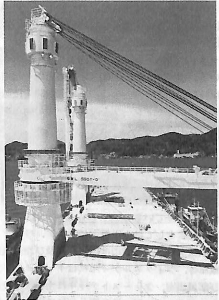
上甲板上の550 Tクレーン（2基）
