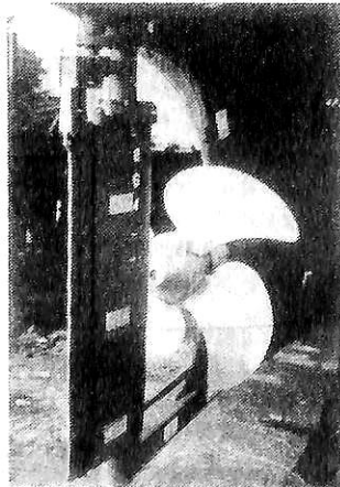
写真左 CPR 65 / 80 VEC 型 可変ピッチプロペラ
