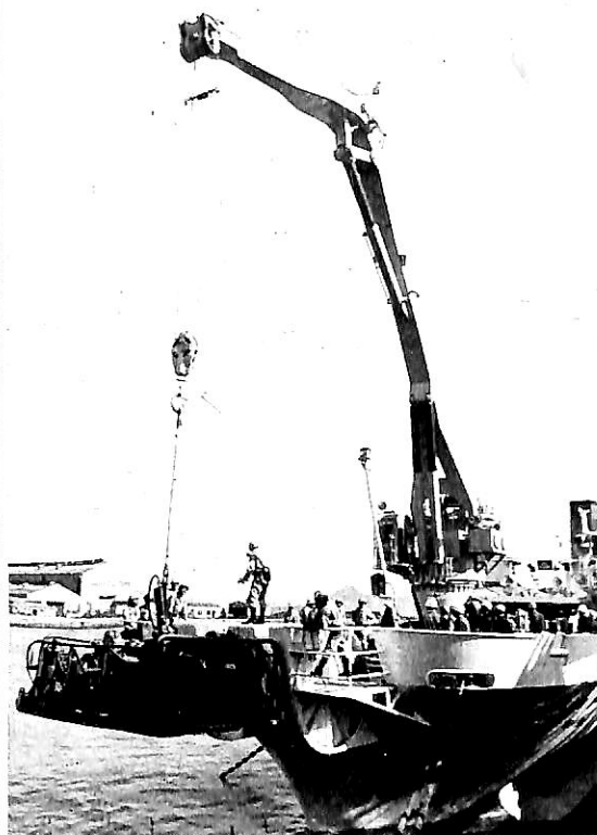
中折式デッキ クレーン (8/3t) 修理用埋設機が吊られている。(船尾)
