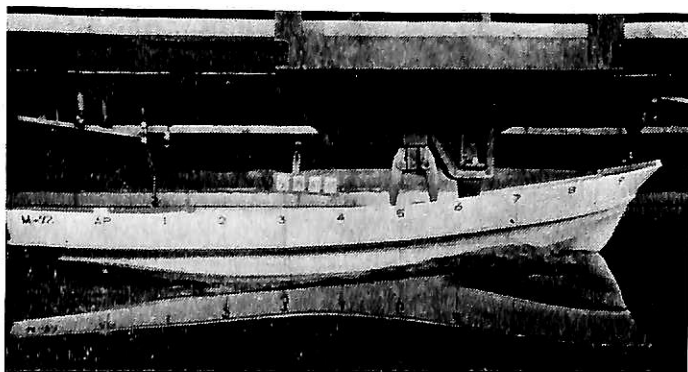
写真2 小型漁船模型の抵抗試験
