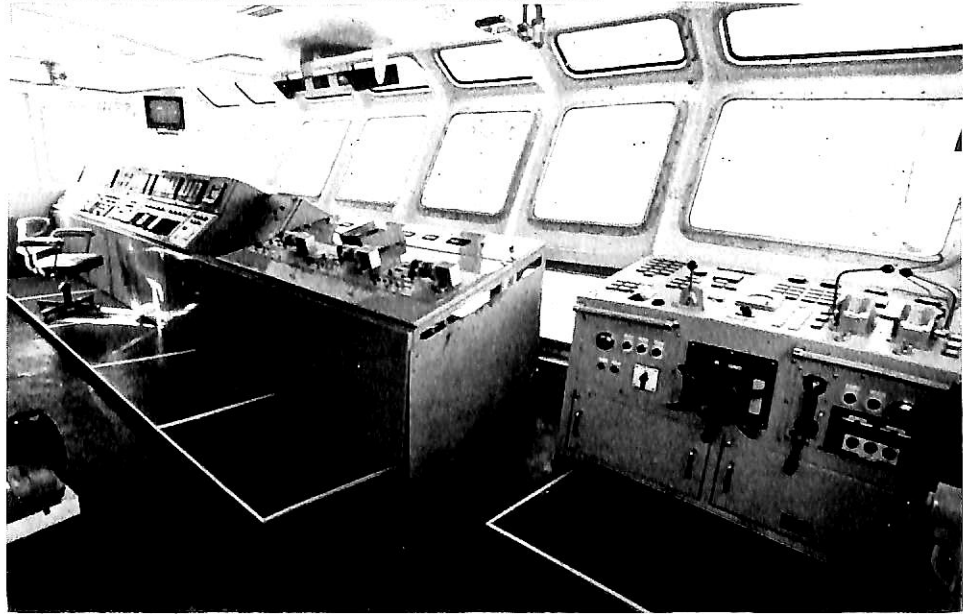
船尾甲板方向の船橋 硫酸タンク関係のリモート コントロール コンソール バーナーブーム装置のコン ピューター集中制御盤もこ こにある。
