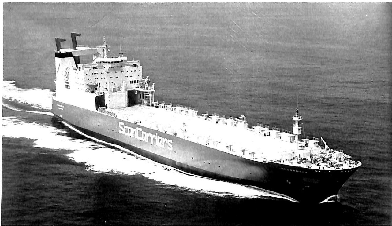
公試運転中の“Boogabilla” 広い甲板と特長ある上部構造，ベンチレータファンハウスはコンテナ積みを考慮してい
