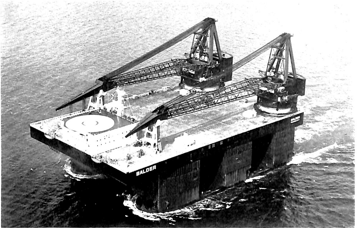
ボルダー 輸出自航式半没水型クレーン船 BALDER
