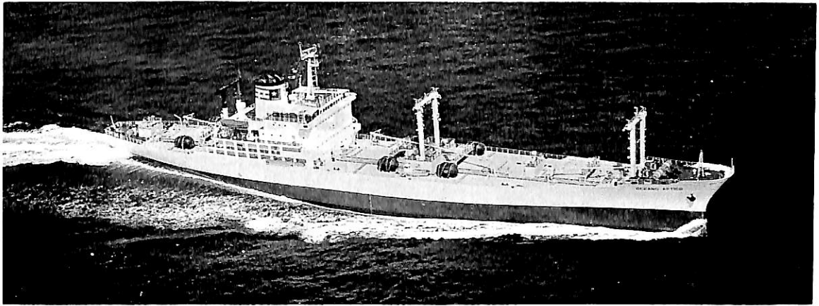
10,540 DWT 高速冷凍船 "OCEANO ARTICO" 船主 CUBA PESCA
