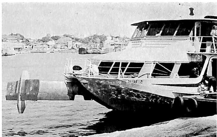
前後部フォイルは艇体航行13kn以下で引き上げられる
