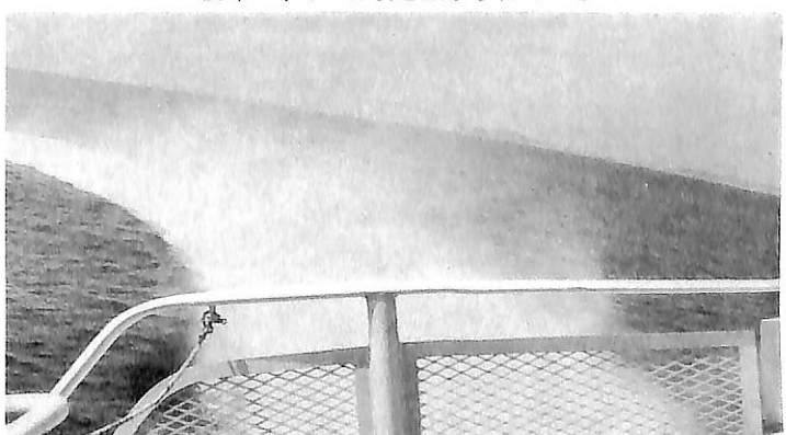
フォイル作動時走行（43kn）の際はストラットが海面に接するだけなので、航跡から生ずる波は殆んどない。又波高3.7mの悪天候下でも縦揺、横揺を感じない。（城ヶ島沖合）
