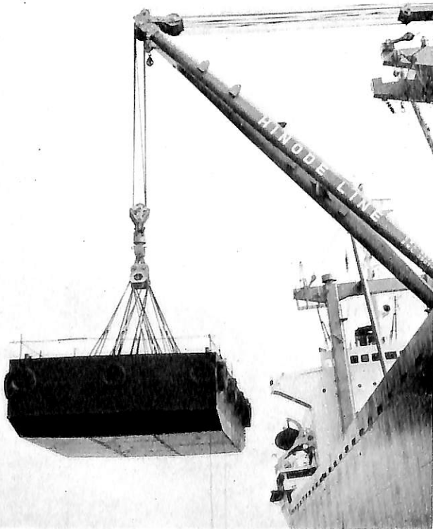
450t 重量物を吊り下げての旋回テスト
