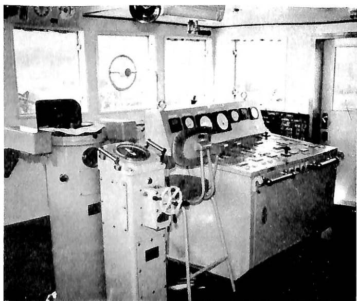
操舵室内 LAG 荷役遠隔操作盤
