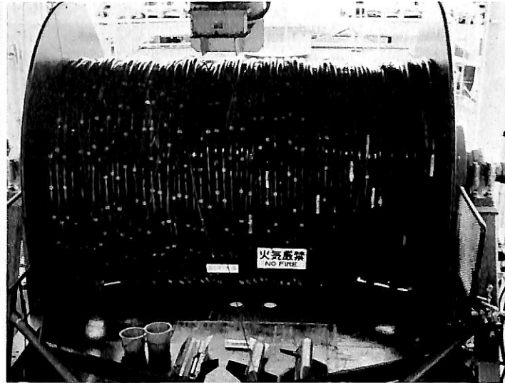
受震器ケーブル全長 2,900m で、50m 間隔に受震計を装着さ せ、10~15mの深度を保って曳航される（船尾甲板搭載）
