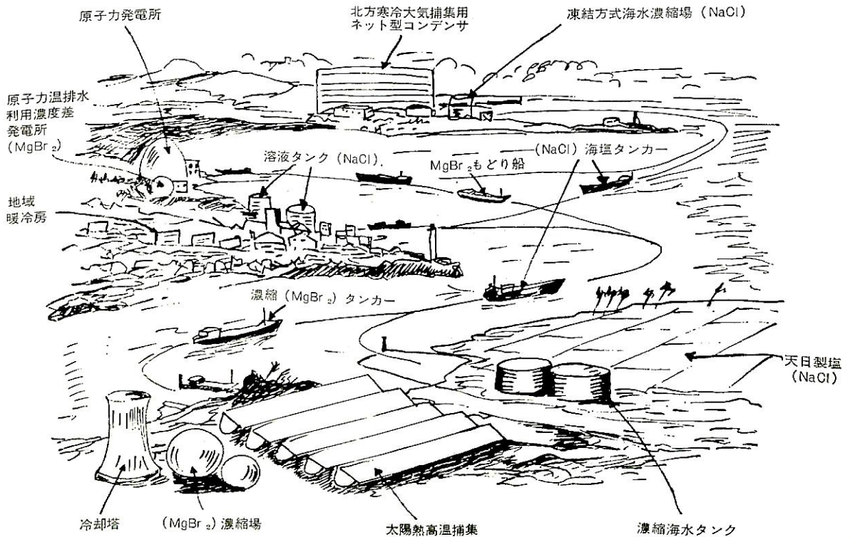
第11図 広域濃度差タンカーシステム (海水の NaCl, もしくは濃縮 MgBr 2 )
