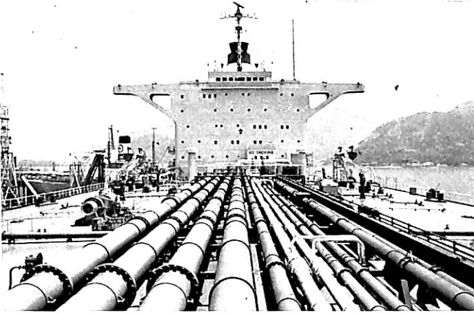
上甲板パイプライン (左: 船橋前面, 右: 船首をみる)
