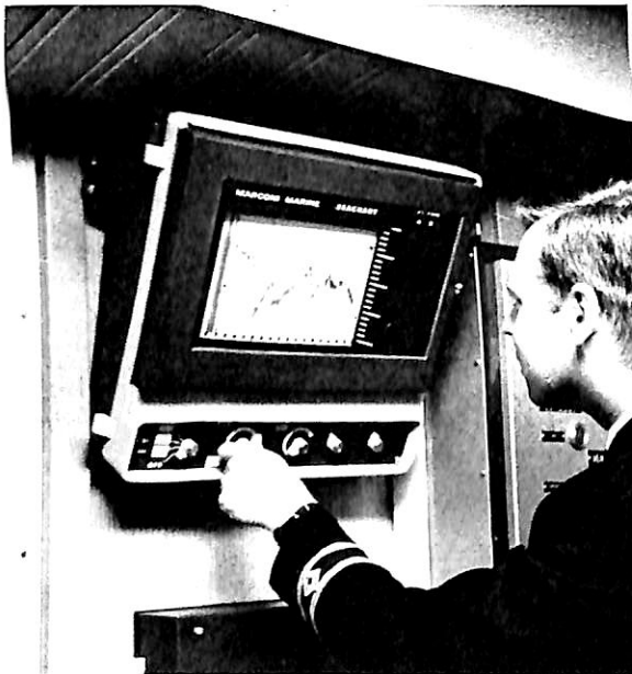
Marconi Marine の Seachart 型音響測深機 (隔壁とか天井のすみに装備して、キャビネットの角度をかえてみる事ができる)
