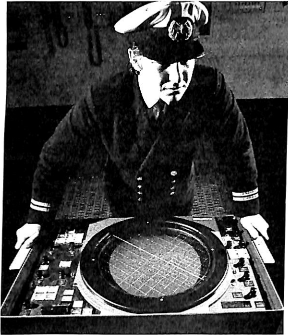
Marconi Marine の Predictor 型自動プロット式の衝突予防レーダー (客船 Northern Star の船橋に装備)
