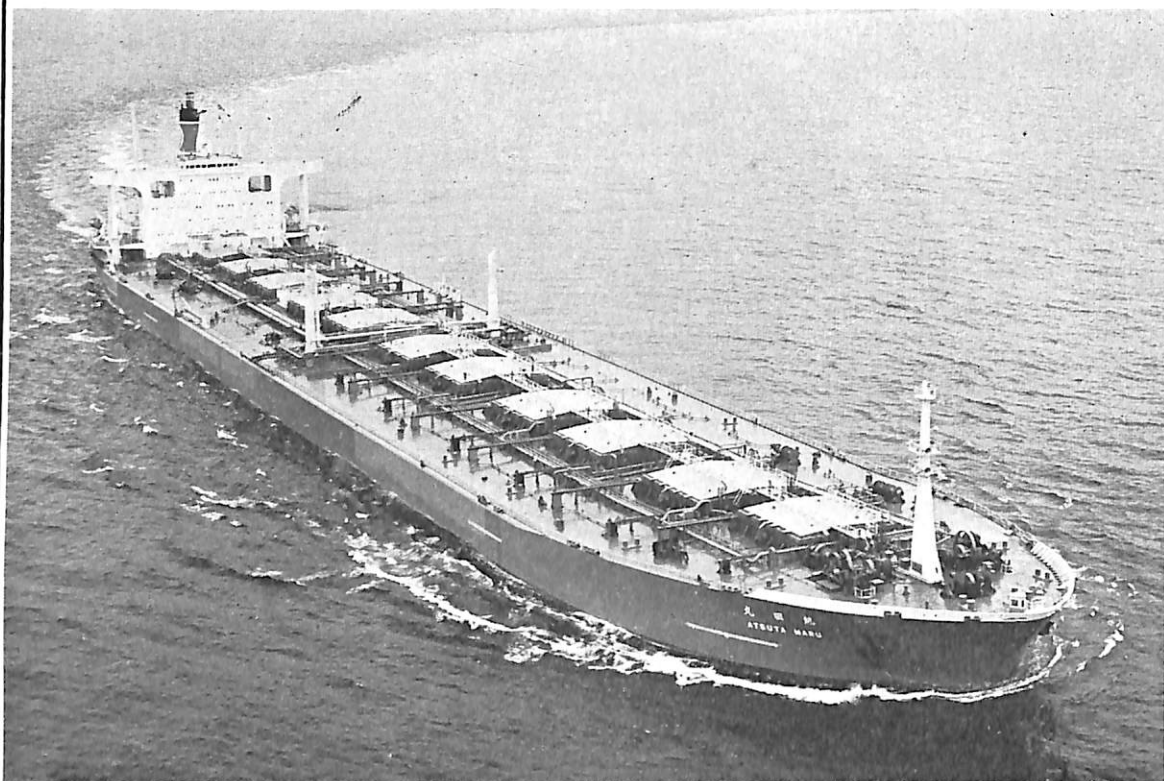
写真 照国海運 鉱石兼油槽船「熱田丸」(215,600DWT) 津造船所で引渡
