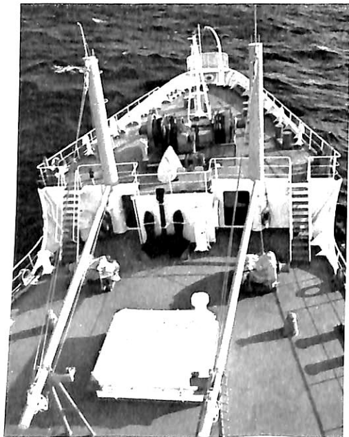
上甲板前部3t荷役装置
