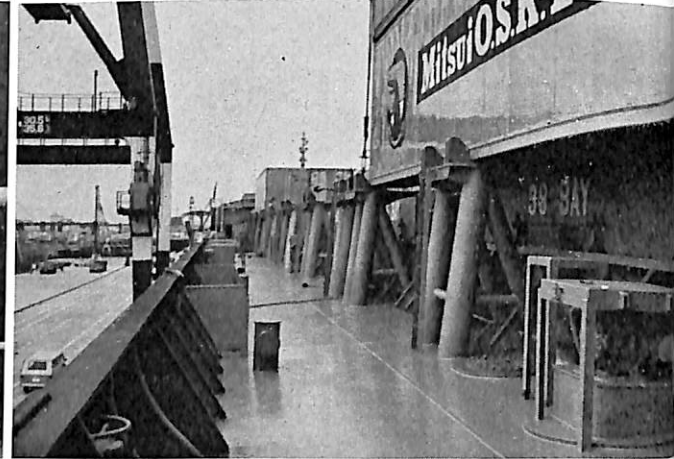
ハッチカバーとベダスタルに跨がって積まれたコンテナ
