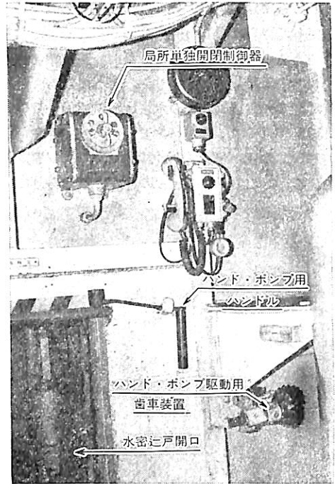
写真 9-4 油圧蓄圧式水密戸の局所単独開閉制御器 (八甲田丸)
