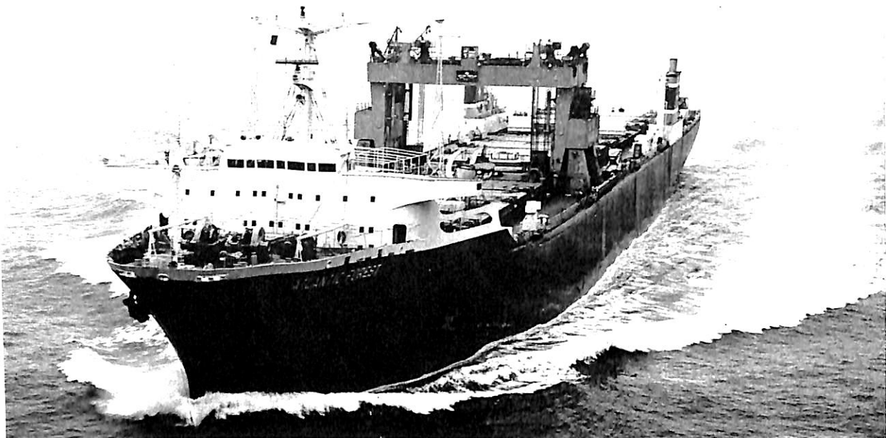
輸出荷役用バージ運搬船 アトランティック フォレスト (LIGHTER-ABOARD-SHIP) ATLANTIC FOREST
