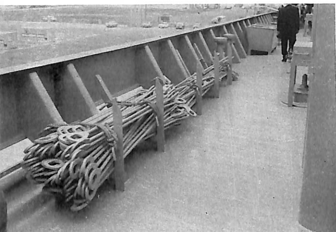
ブルワークに沿って格納された ラッシング・ロッド
