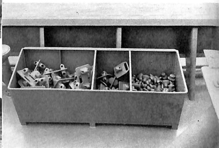
甲板上舷側の格納箱に収められたラッシング金物 向って左側より ◦ Vertical Stacker (double) ◦ 同上 (single) ◦ Upper Securing Fitting
