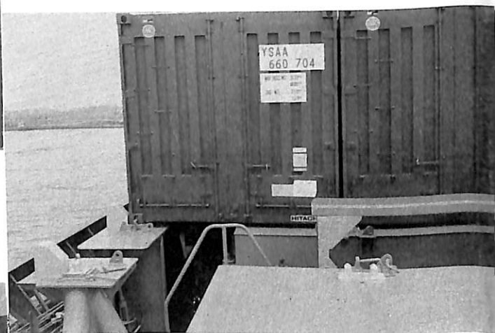
No. 4 Bay 上に積まれたコンテナ 舷側寄りのコンテナは片側を甲板から突出した Pedestal 上に乗せる コンテナ手前のハッチカバー間に見えるのがラ ッシング用のステージ
