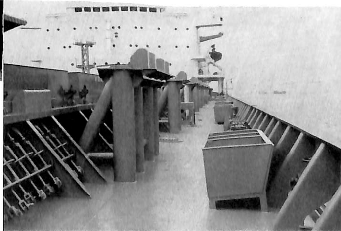
ハッチ・コーミングに沿わせてラッシング用 Turn Buckle が格納されている。コンテナ を受ける Pedestal が並んでいる。
