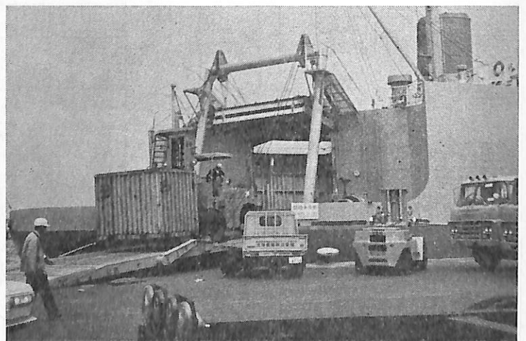
写真1 コンテナのロールオン
