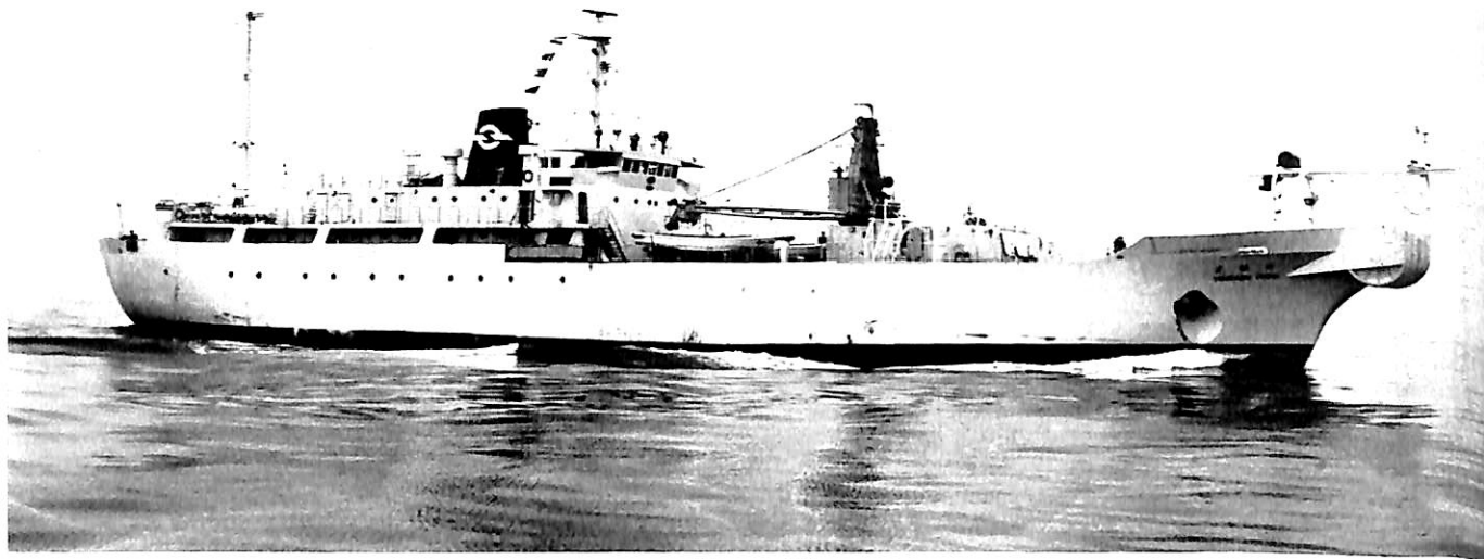
海底ケーブル敷設船 津 軽 丸 日本電信電話公社 TSUGARU MARU
