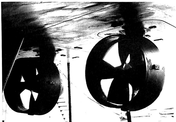
船尾プロペラ装着状況(プロペラは後進状態)
