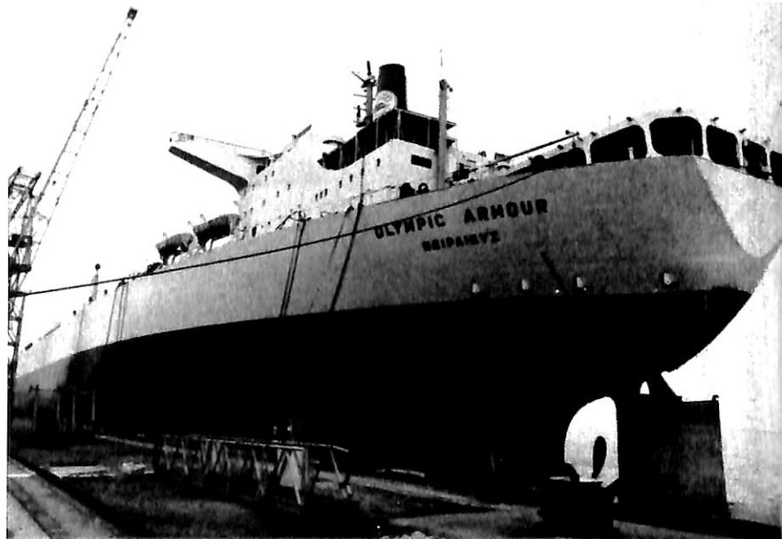
船尾部外景 船尾甲板はハリコブタ ハブラットフォーム
