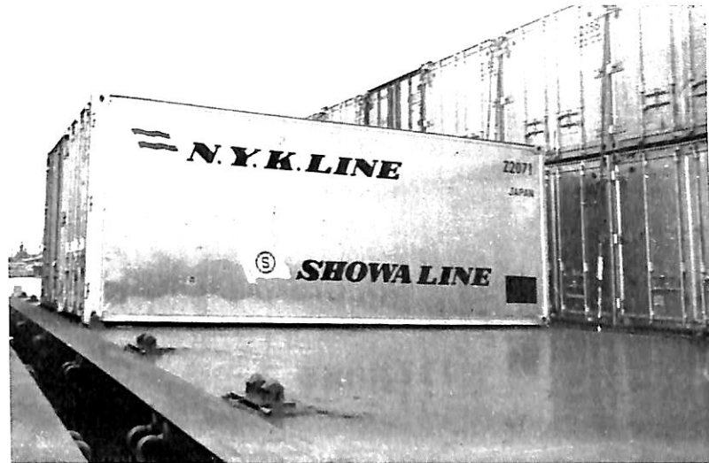
ハッチカバー上のコンテナ2段積み（ポジショニングコーンでコンテナを固着する）
