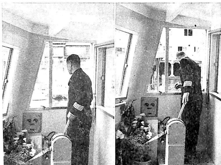
写真 2・4 着岸操船時の船長による補助操縦スタンドの使用 (その1) (安芸丸)
