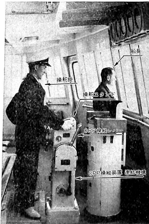
写真 2・3 高速航行時の安芸丸の操舵室
