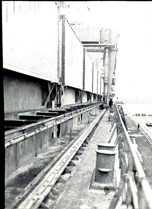
日本における最初のコンテナ船(MATSON社向)コンテナ、クレーン、船体貨油タンク内に対し Dimetcote および Amercoat 塗料施工
