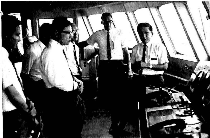
操舵室（右側のブリッジコンソールスタンドにスクラム指令装置もみえる）
