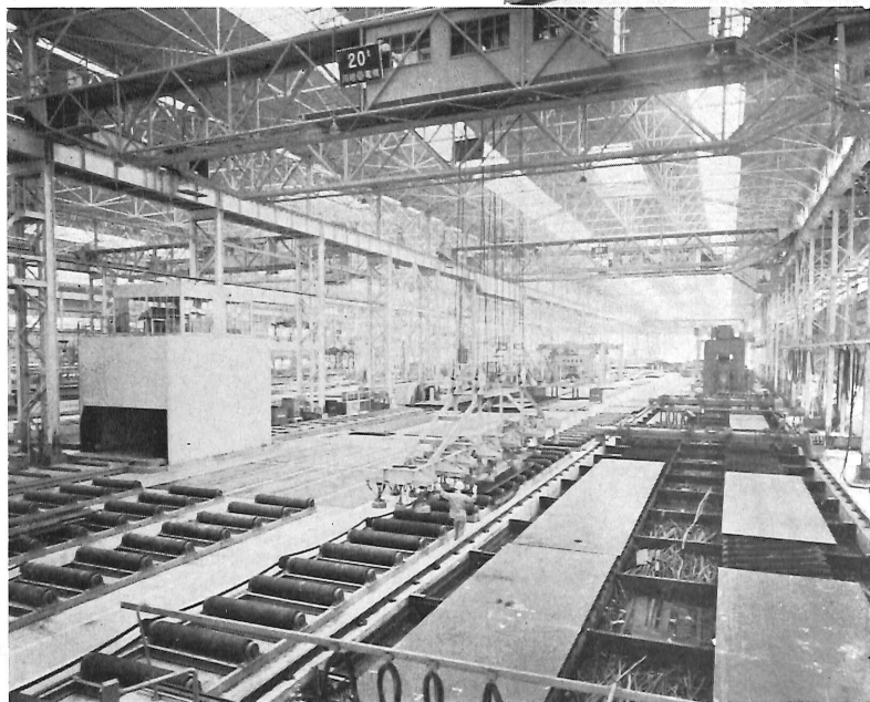
船殻内業工場内部 (右側は自動ガス切断機)
