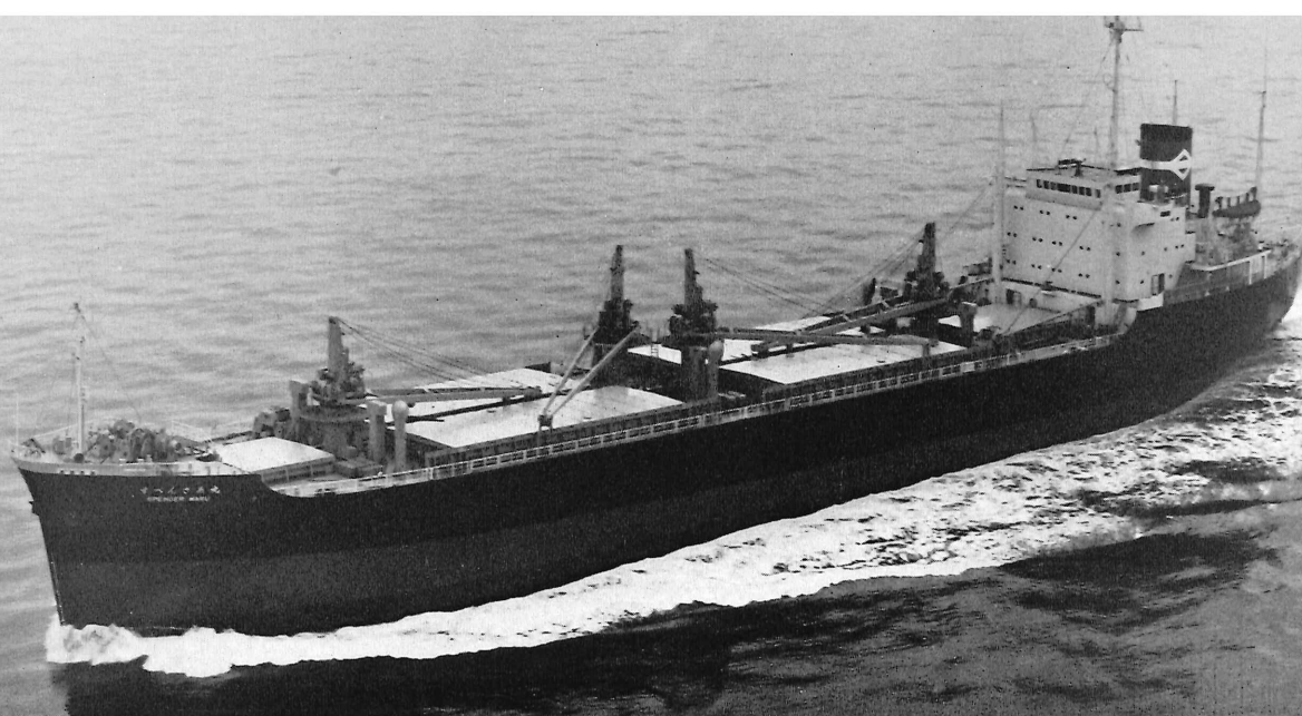
22次銅・亜鉛・鉛精鉱専用船 すぺんさあ丸 第一中央汽船株式会社 SPENCER MARU
