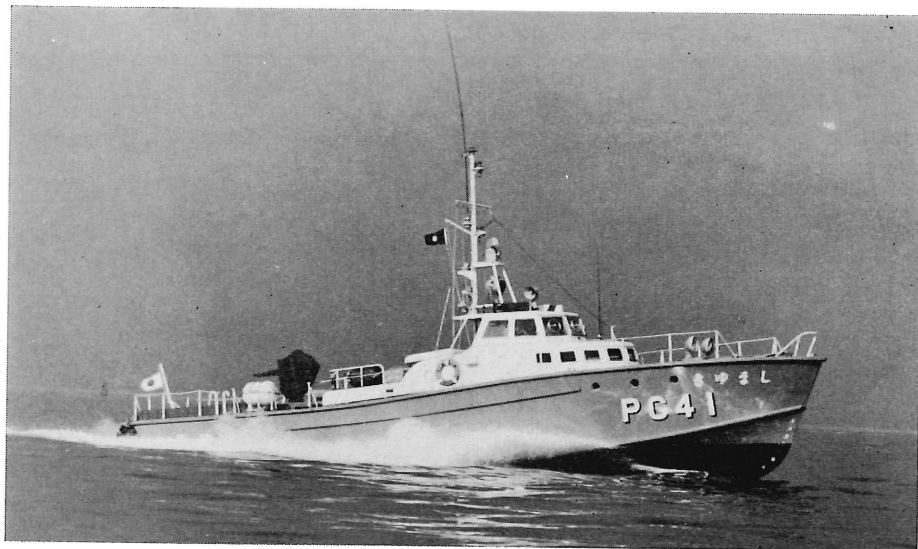
巡視艇 しまゆき 全長 21 m 排水量 40 t 最大速力 27 kn
