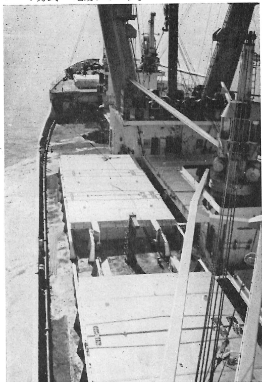
Stülckenの130tヘビーデリック1基を備え、重量運搬船なみの装備でライナーの荷役装置では世界最大。ウインチはワードレオナード方式15t電動ウインチ。
