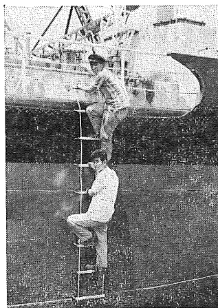
舷側に取付けて昇降する状態
