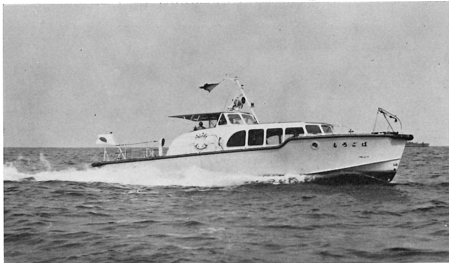
監視艇 はごろも 全長 15 m 排水量 15.7 t 最大速力 21 kn
