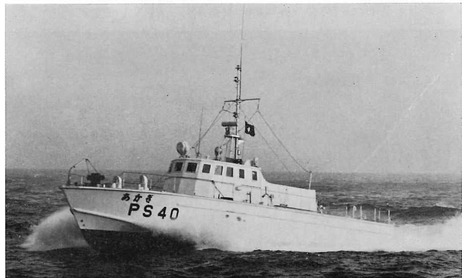
巡視艇 あかぎ 全長 24 m 排水量 43.9 t 最大速力 29 kn
