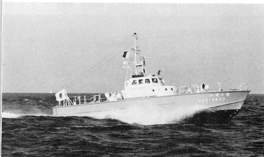
漁業取締艇 ほくせい 全長 18 m 排水量 19.7 t 最大速力 20 kn
