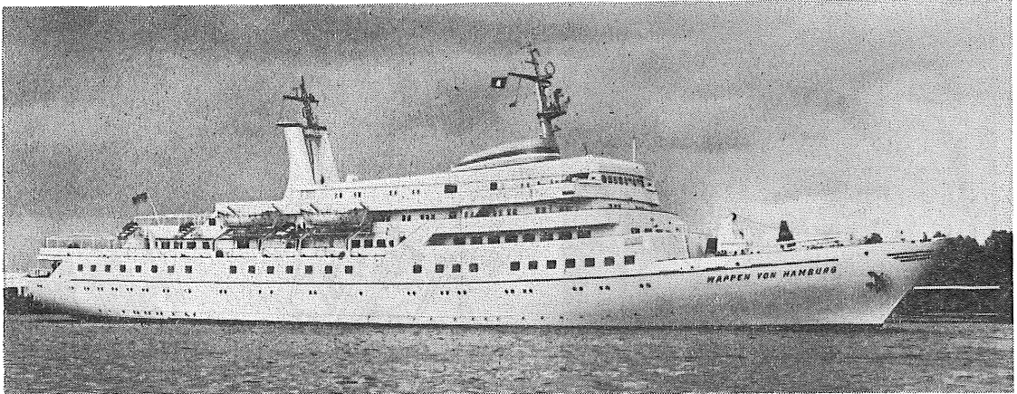
第7図 Wappen von Hamburg号 (主機 2×V6V40/54各 5,080BHP×353rpm)
