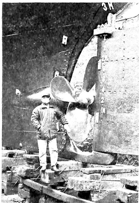
写真 1 FRPプロペラ装着例 (直径 1,850mm)
