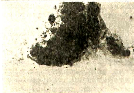
C重油の夾雑物の顕微鏡写真 約250~150 \mu (約3,600倍)
