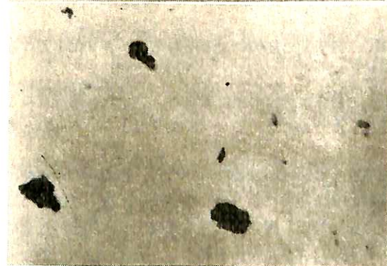
C重油にて超音波を照射した後の 分散した夾雑物 約10~20 \mu (約3,600倍)
