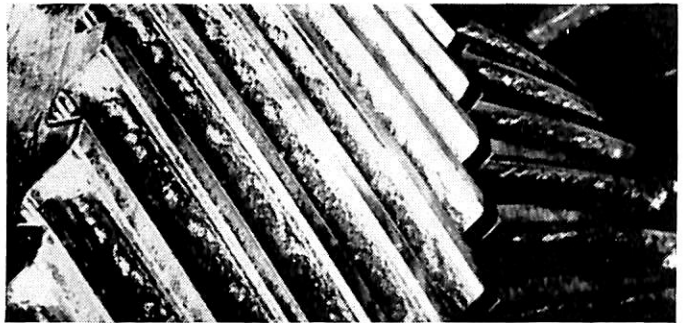
・ギア歯面一面に発生したピッチング
