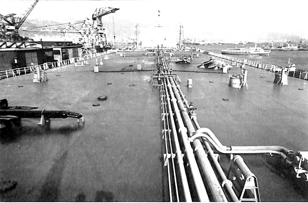
上甲板パイプライン
