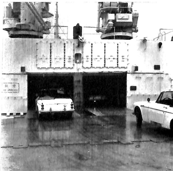
カーエレベーターへ自走する
