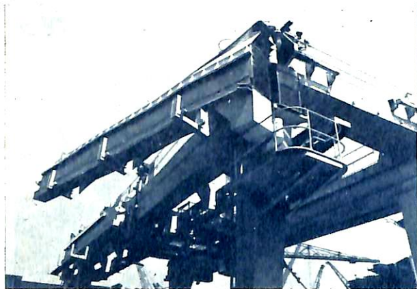
SUAN号(24,000D.W T撤積船)に搭載された15t型ムンクローダー
