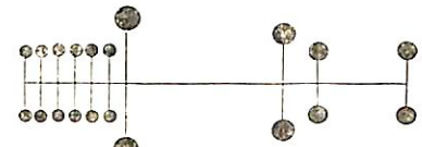
4機1軸機関クランク軸ねじり振動
