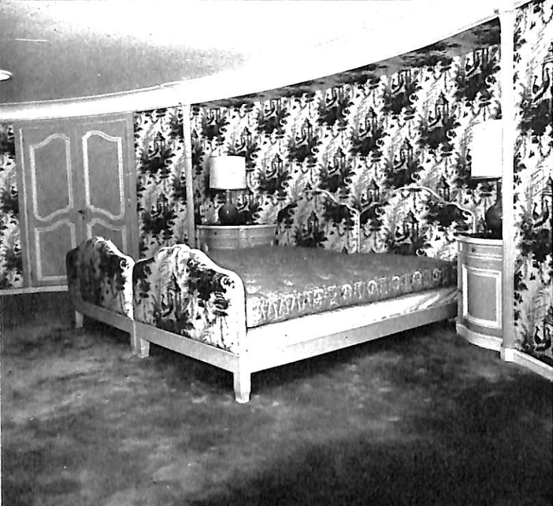
船主寝室。壁はブルーと白のパゴダ模様、フランス製コットン地、蛇腹部分は FRP の off white 仕上げ、キャビネット、ワードローブの仕上げはアンティークペイント仕上げ、ベッドは壁と同一裂地張り。
