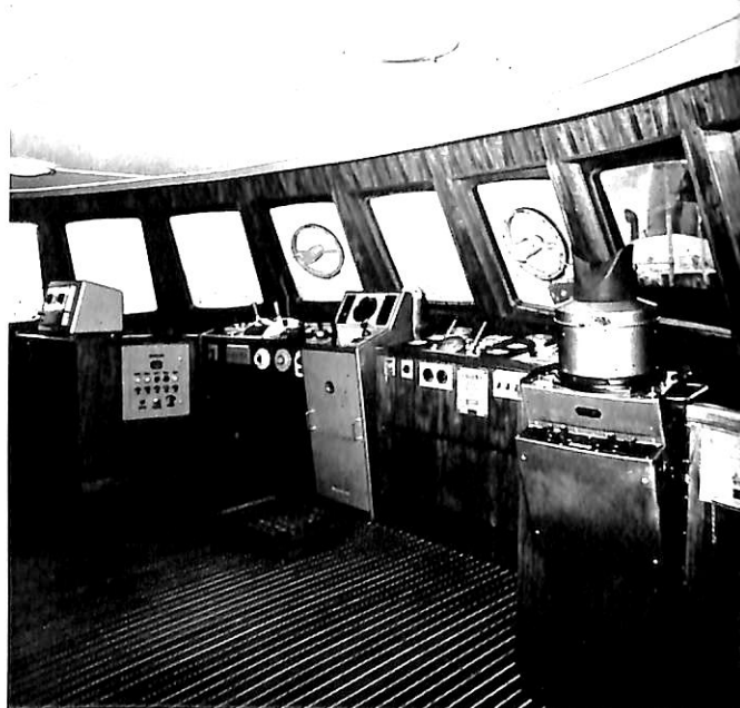
操舵室。2台の主機のリモートコントロール装置を配し、コンソール型。壁はチークのツキ板張り。床はチーク張り、白のシムコパウンド使用。
