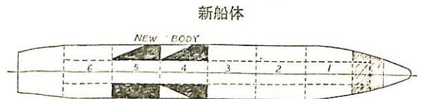
第2図 船橋移設作業時の水バラスト配置 (注、下記以外の諸タンクは全部空とす)
