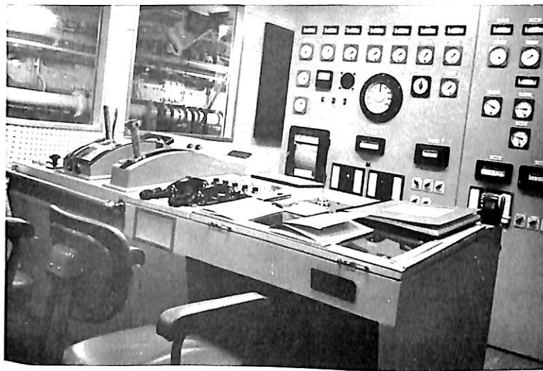
機関制御室の主機遠隔操縦台 (窓をとおして主機がみえる)
