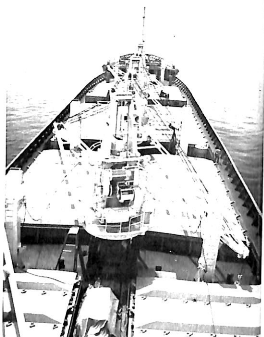
二列艙口とデッキクレーン
