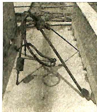
2-4 図 ヤハタ式反転型グラビティ溶接機。この溶接機ではビード終端においてホルダの位置を反転させることにより自動的にアークが切れるように工夫されており、機構がかんたんで故障が少ないのが特徴である。使用溶接棒の長さは70mm(現在は2-12図に示す無指向式のものに変わりつつある)
