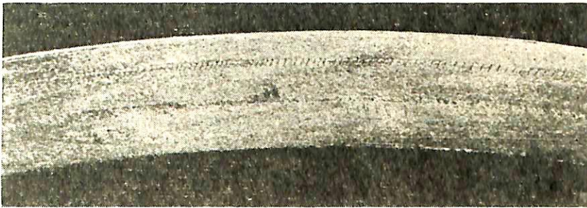
写真5 ピストンリングの上下面に見られる機械的膠着の圧痕
