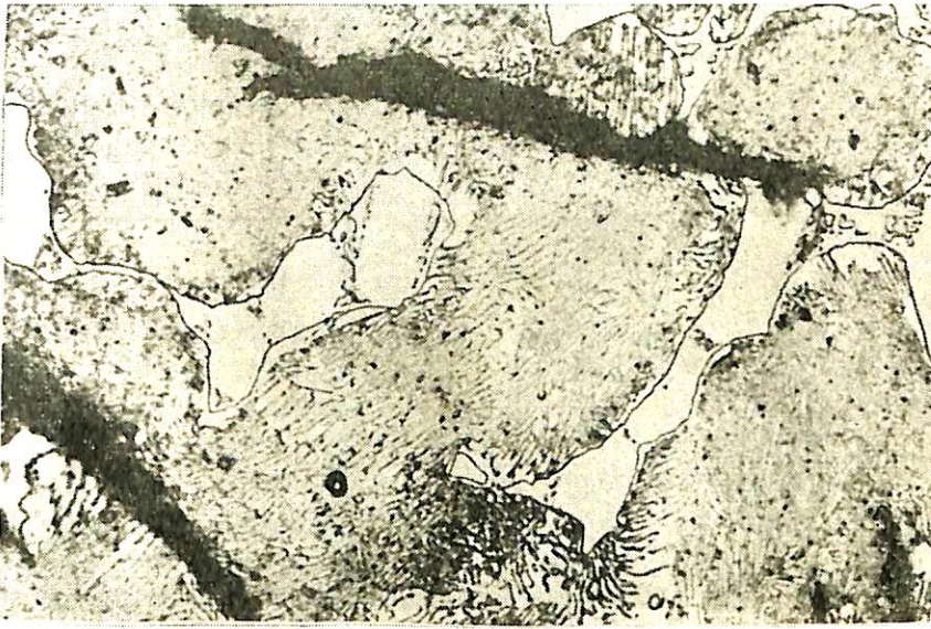
写真3 ボロン鋳鉄組織写真 (5%ピラクル)(×1,000) (化学成分)
