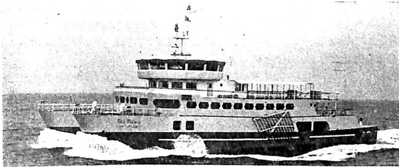
写真4 シーパレス（双胴型旅客船）435GT 650PS 各胴1基 計2基
