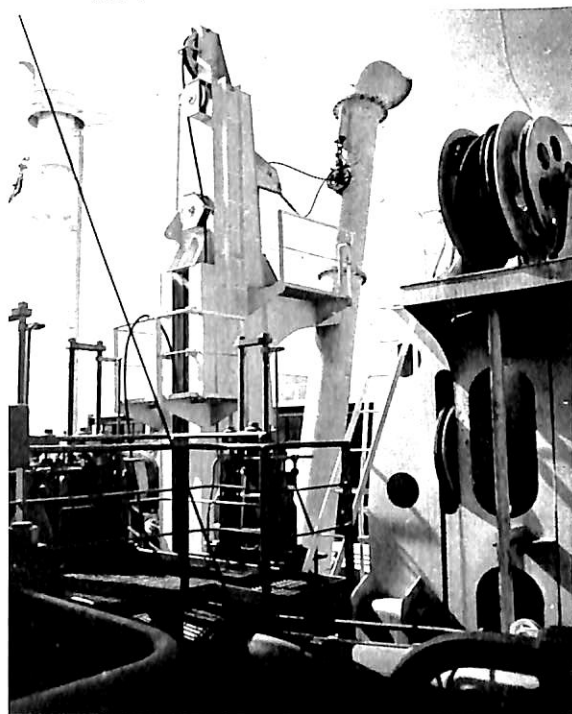
写真 9 陸上排送管および格納装置
