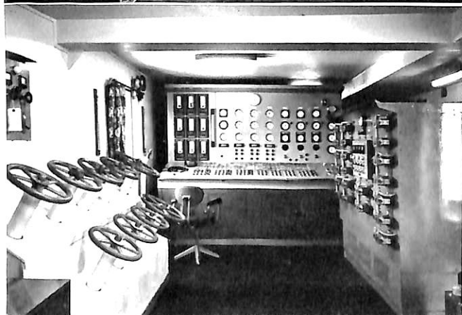
← 貨油管系のバルブおよびポンプのコントロール・ルーム
