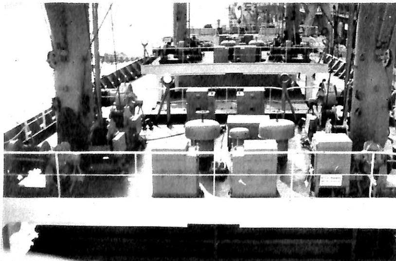
ウインチプラットフォーム（中央部にコントロールスタンドがある）
