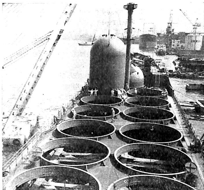
LPG貯蔵タンクの積み込み
