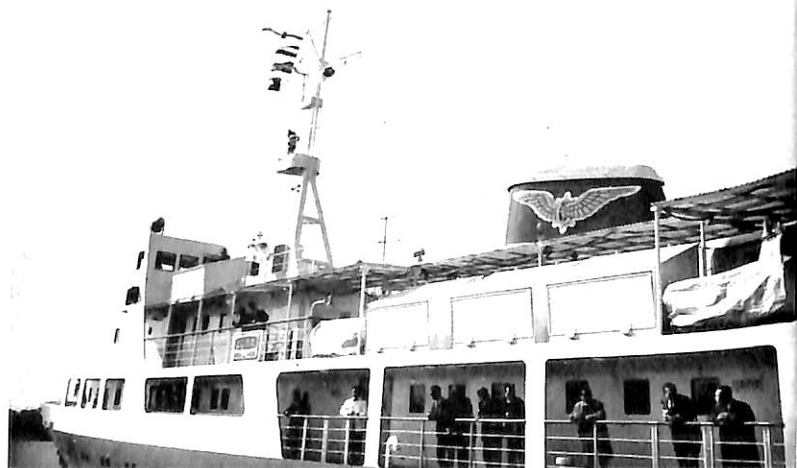
救命艇のかわりに膨脹型救命筏を設けている。
