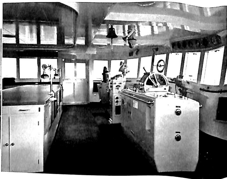
船橋操舵室内部 右手前がコンソールスタンド 左側は海図台
