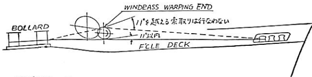
第4図 ウィンドラス・ワーピングエンドの索取り 5. コントロール
