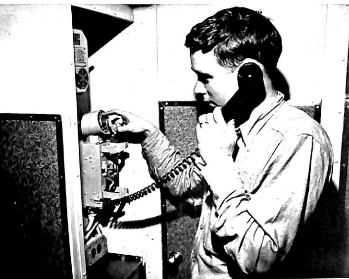
艦内のダイヤル式電話が TRITON に初めて装備され、陸上との電話連絡もできる。
