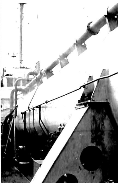
No.1 LPGタンク撒水試験中
